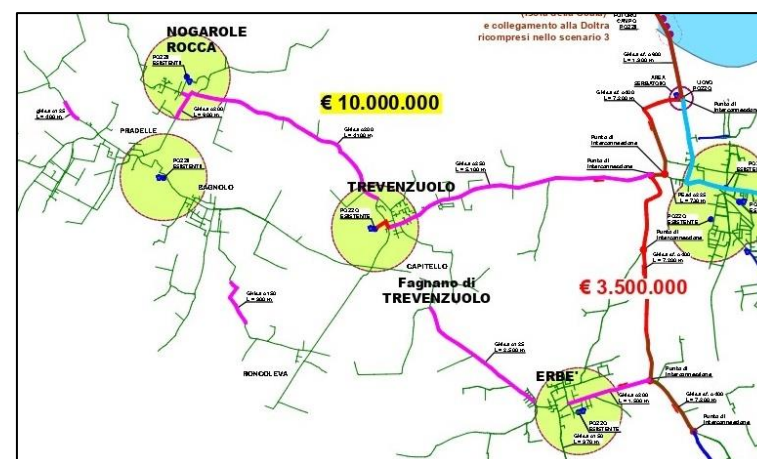
Figura 5.5: Stralcio delle opere della "Dorsale sud" per l'interconnessione dei territori ex-CISI.
