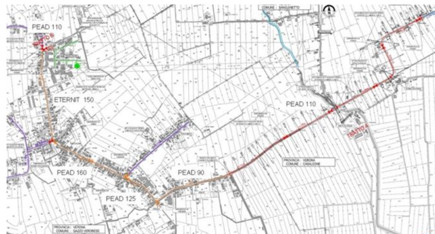
Figura 5.3: Stralcio planimetrico dell'intervento per la "Realizzazione della rete idrica a servizio della frazione Maccacari"
