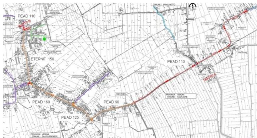
Figura 5.4: Stralcio planimetrico dell'intervento per la "Realizzazione della rete idrica a servizio della frazione Maccacari"
