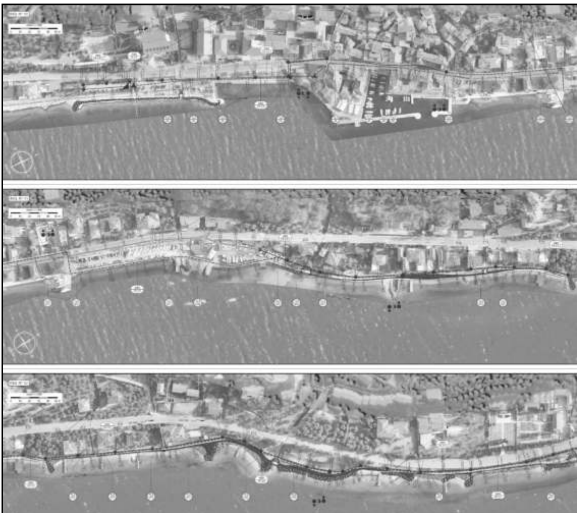
Figura 29: Sistemazione a scogliera in fase di realizzazione ed in progetto a Castelletto in Comune di Brenzone sul Garda di competenza di realizzazione del progetto della pista ciclabile
