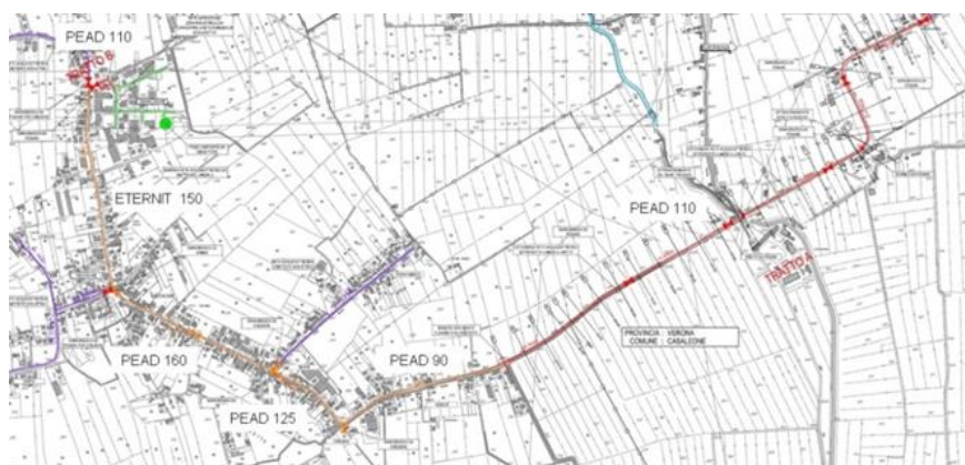
Figura 5-4: Stralcio planimetrico dell'intervento per la "Realizzazione della rete idrica a servizio della frazione Maccacari"
